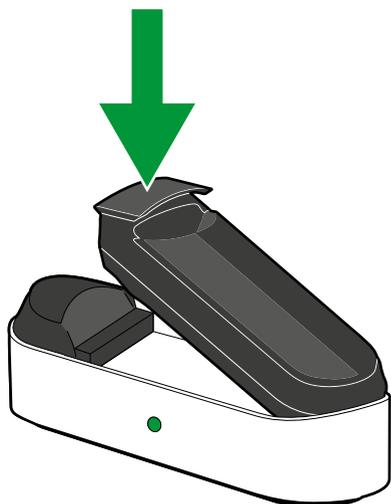
Setzen Sie den zu ladenden Akku in die Aufnahme des Ladegeräts. Drücken Sie die grüne Taste zum Deaktivieren des Transportmodus (z.B. bei Erstinbetriebnahme oder nach Tiefentladung).
