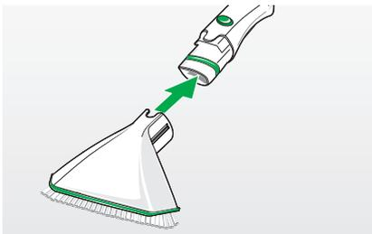
Bild 3.31 Glasdüse auf Elektrosaugschlauch aufstecken
