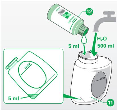
Bild 3.22 Dosierflasche befüllen
