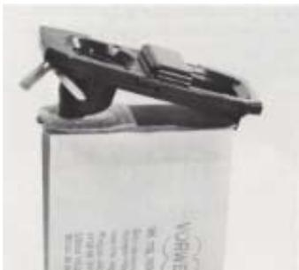
Luftdurchgang im Kassettendeckel von eventuellen Verstopfungen befreien. Pappdeckel der neuen Filtertüte mit den beiden Nasen in die Haltevorrichtung an der Seite des Kassettendeckels schieben, dann über den Stützen schwenken und andrücken, bis er fest einrastet.
