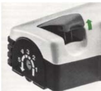
Zum Nachstellen der Rundbürste den gelben Hebel bi zum Anschlag nach oben ziehen (ein- oder zweimal), bis die Positionsmarkierung an der Bürste auf die nächste Zahl zeigt. Nur bei der ersten Zahl, an der die grüne Lampe wieder aufleuchtet, ist die Teppich-Bürste richtig eingestellt. Sie darf nicht weiter nachgestellt werden. Falls die Positionsmarkierung zu weit gedreht wurde, läßt sie sich nur über die Position 5 hinaus durchschalten und auf die gewünschte Position einstellen.
