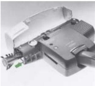
Die Rundbürsten an dem weißen bzw. roten Ring fassen aus dem Bürstentunnel ziehen. Die neuen Rundbürsten mit einer leichten Drehung bis zum Einrasten auf die Antriebswelle drücken. Bürsten den farbigen Dreiecken entsprechend (weiß zu weiß, rot zu rot) zuordnen. Immer beide Rundbürsten wechseln.
