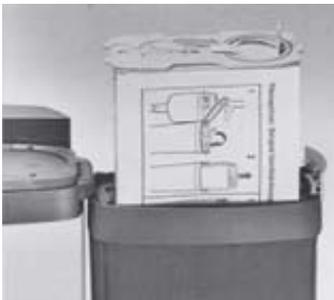
Filtertüte der Halteplatte aus der Kassette herausziehen und in den Müll werfen. Die Filtertüte kann auch zusammen mit der Filterkassette abgenommen und zum Müll getragen werden. Dazu Kassette einfach im Scharnier verkanten.
