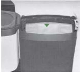
Die Filterkassette ist innen mit einem Hygiene-Feinfilter ausgekleidet, der alle Staubteilchen über 3/1000 mm festhält. Die ausgeblasene Luft ist sauberer als die Raumluft.
