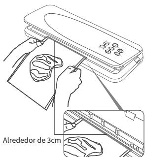
3. Coloque los ingredientes en una bolsa de sellado al vacío o en un film para el vacío pre sellado. A continuación, encaje la abertura en el dispositivo de forma adecuada.
