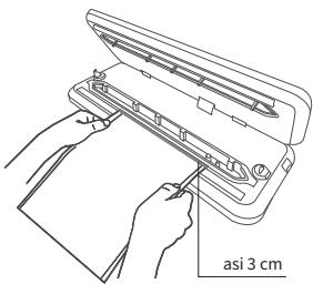
3. Pomocí zastřihovače ořízněte fólii na požadovanou délku.
