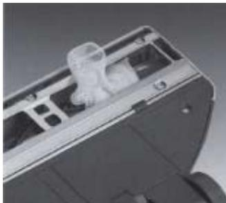
**Blockierschutz:** Werden einmal versehentlich größere Teile eingesaugt, schaltet sich die Elektrobürste automatisch ab (Der Kobold regelt sich auf Minimalleistung herunter.) Das Blinken der Kontrolllampe (**B**) weist auf die Blockierung hin. Entfernen Sie bitte das eingesaugte Objekt. Nach dem Wiedereinschalten können Sie wie gewohnt weitersaugen.
