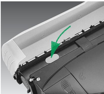
**Die Elektrobürste lässt sich schwer schieben:** Das kann zum Beispiel auf Feinvelours der Fall sein. Dann stellen Sie den Schiebeschalter des Saugers auf Minimalleistung. Falls sich die Elektrobürste weiterhin schwer schieben lässt, sollten Sie die Haube aufklappen (siehe „Auswechseln der Rundbürste“), den gelben Stopfen entfernen und so das Ansaugen von Nebenluft ermöglichen.
