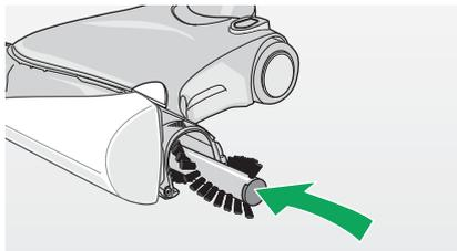
Bild 2.9 Rundbürsten einsetzen
