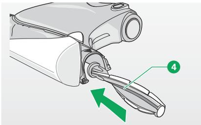
Bild 2.14 Matratzenbürste einsetzen
