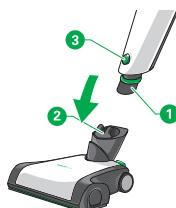
1. Inserte el conector de accesorios (1) del aspirador sin cable en la articulación del cepillo eléctrico (2).
