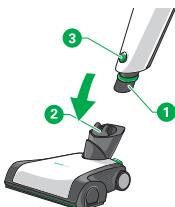
1. Stecken Sie den Anschlussstutzen (1) des Akku-Staubsaugers in das Gelenk der Elektrobürste (2).
