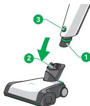
1. Vsuňte připojovací kloub (1) tyčového aku vysavače do kloubu elektrického kartáče (2).
