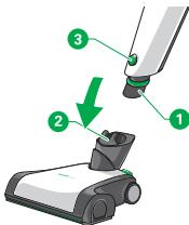
1. Insérez l'embout de raccordement (1) de l'aspirateur sans fil dans l'articulation du brosseur (2).
