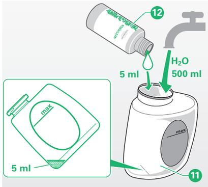
Bild 3.6 Dosierflasche SP 520 befüllen
