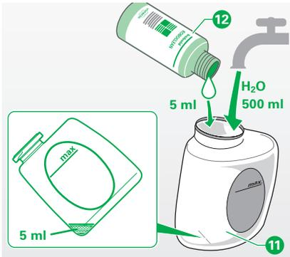
Bild 3.6 Dosierflasche befüllen
