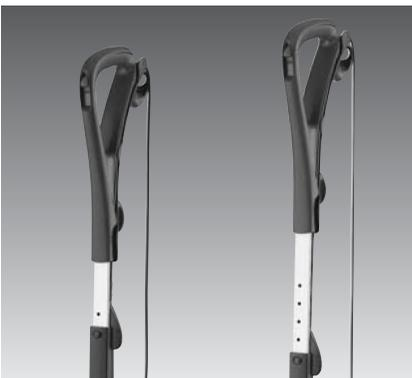
Der Teleskopstiel hat sechs verschiedene Längen. Um die Länge zu verändern, drücken Sie den Entriegelungsknopf und schieben den Stiel ineinander ins Gerät oder ziehen ihn auseinander. Sobald der Knopf nicht mehr gedrückt wird, rastet der Stiel bei der nächsten Stellung ein.
