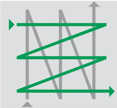
und führen Sie ihn Bahn neben Bahn und dann quer dazu über die bestreute bzw. eingesprühte Fläche.
