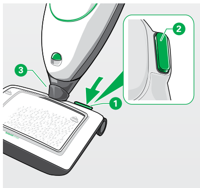
Bild 4.1 Teppichfrischer richtig mit dem Staubsauger verbinden und Tritt-schalter ausreichend drücken
