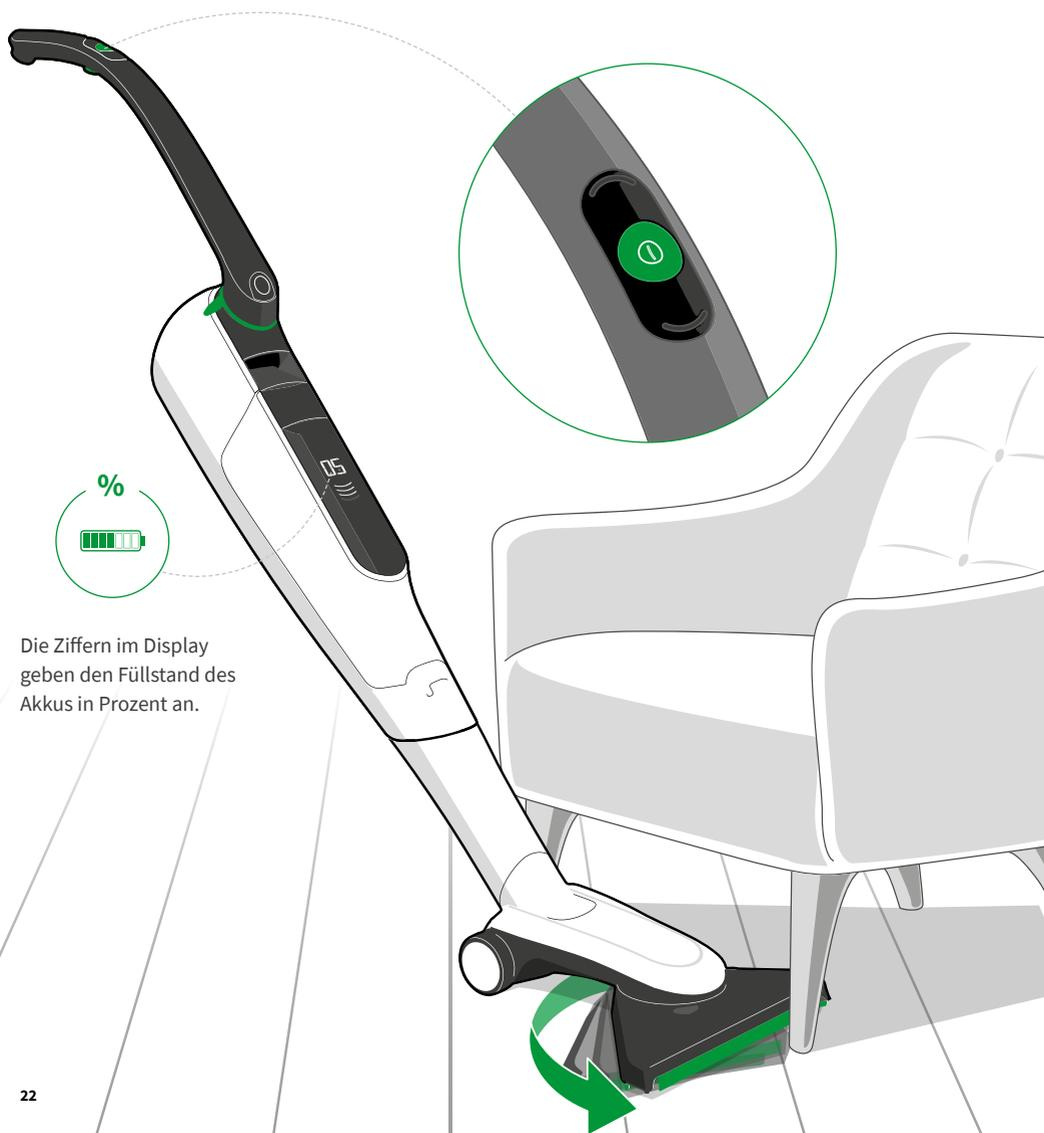
Die Ziffern im Display geben den Füllstand des Akkus in Prozent an.
