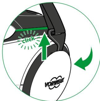
Hängen Sie den Gurthaken in das hintere Ende des Akku-Staubsaugers ein. Ziehen Sie den Haken nach oben, bis er hörbar einrastet.
