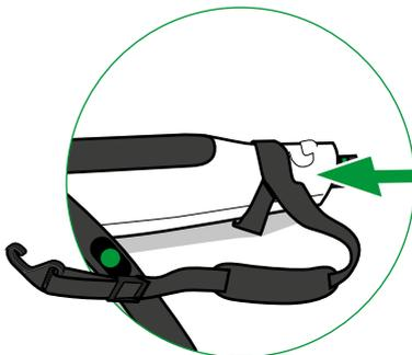
Schieben Sie den vorderen Teil des Akku-Staubsaugers in die Schlaufe des Schultergurts ein.
