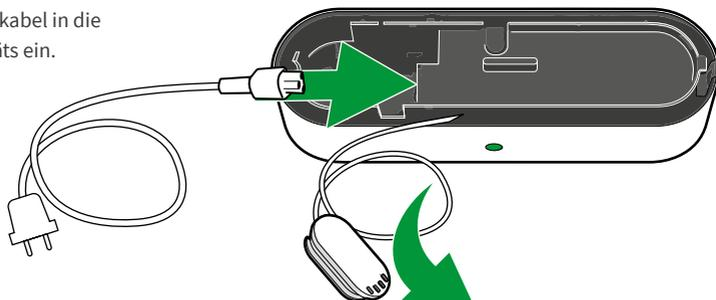
Mit dem Ladekabel wird das Ladegerät mit dem VK7 Akku-Staubsauger verbunden (siehe „Akku laden“ auf Seite 8).
