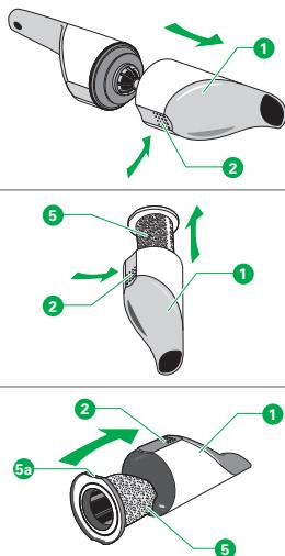
1. Drücken Sie die Entriegelungstaste (2) und nehmen Sie die Staubkammer vom Gerät ab.
