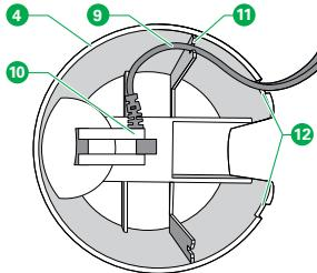
1. Stecken Sie das Netzkabel (9) in die dafür vorgesehene Ladebuchse (10) an der Unterseite der Ladestation (4).
