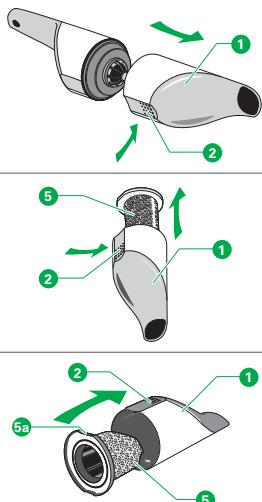
1. Premere il pulsante di sblocco (2) e staccare la camera di raccolta della polvere dall'apparecchio.
