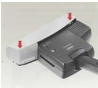
Die elastische Haube wieder zuklappen: mit den Händen an beide Seiten führen und andrücken, bis sie eingerastet ist.
