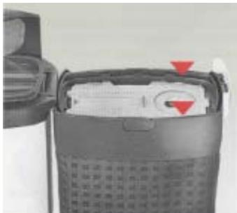
Neue Filtertüte in Längsrichtung glattziehen und in die Filterkassette versenken. Halteplatte mit den beiden Nasen in die Aussparungen an der Motorkopfseite legen und in Höhe der Filtertüten-Öffnung auf den Rahmen drücken, bis sie deutlich hörbar einrastet.
