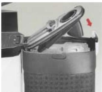
Filterkassette mit der Dichtklappe verschließen – **Federklappe dabei auf keinen Fall mit der Hand festhalten** –
