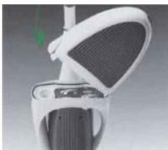
Dazu ziehen Sie einfach an der gelben Entriegelungsklappe (**K**) und klappen die Filterkassette (**II**) zur Seite.
