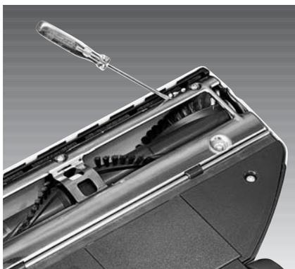
Kontrollieren Sie hin und wieder die Unterseite, damit Gerät und Boden keinen Schaden nehmen. Haben sich z. B. Steinchen in den Frontdüsen festgesetzt, können Sie diese Gegenstände am besten mit einem spitzen Gegenstand, z. B. Schraubendreher, entfernen.
