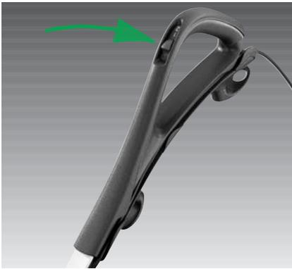
**Einschalten und Ausschalten** geschieht mit dem Schiebeschalter am Handgriff. Mit dem Schiebeschalter stellen Sie auch die gewünschte Saugleistung ein. Bei jedem Einschalten durchläuft der Kobold als Selbsttest zunächst alle Leistungsstufen bis zur maximalen Leistungsstufe „3“ und stellt sich dann auf die eingestellte Stufe ein. Die Elektrobürste schaltet sich automatisch mit ein oder aus.
