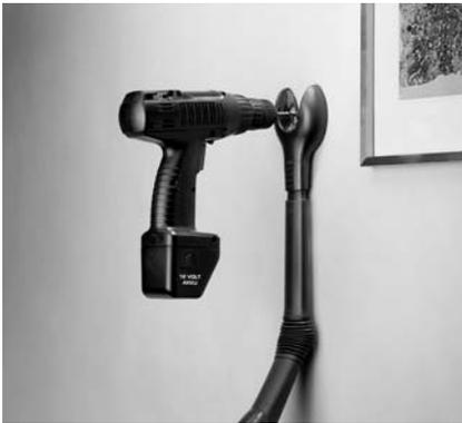
**Bohrstaub direkt vor Ort absaugen:** Schalten Sie dazu Ihren Kobold ein und platzieren Sie die Bohrstaubdüse um das vorgesehene Bohrloch – sie saugt sich an der Wand fest.
