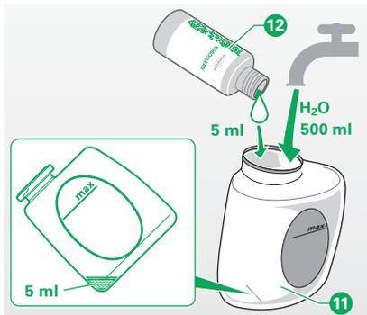
Bild 3.22 Dosierflasche SP 520 befüllen
