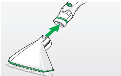
Bild 3.34 Glasdüse auf Elektrosaugschlauch aufstecken
