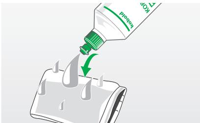
Bild 3.36 Koboclear auf Glasstück auftragen
