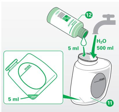
Bild 3.22 Dosierungsflasche befüllen
