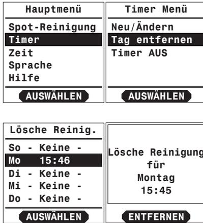
Bild 3.9 Planmäßige Reinigung löschen
