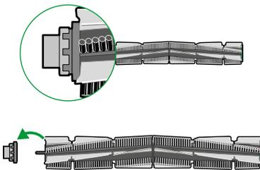
Um die Rundbürste und die Bürstenabdeckung wieder einzusetzen, folgen Sie der Beschreibung zum Entfernen der Rundbürste in umgekehrter Reihenfolge. Achten Sie darauf, dass die Verschlussriegel beim Einsetzen der Bürstenabdeckung hörbar einrasten.
