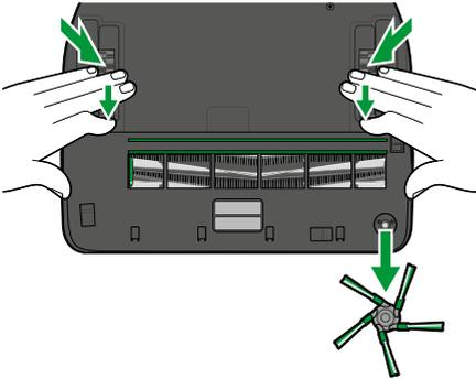
Entnehmen Sie die Rundbürste. Heben Sie zuerst die rechte Seite der Rundbürste aus dem Saugroboter und ziehen Sie anschließend die linke Seite von der Achse ab.
