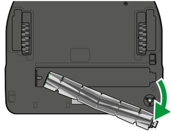
Entfernen Sie die gelbe Schutzkappe mit dem metallischen Aufsatz am linken Ende der Rundbürste. Achten Sie darauf, dass sich das innenliegende Lager nicht löst. Entfernen Sie Flusen, Haare und anderen Schmutz von der Rundbürste.
