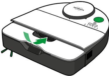
Entnehmen Sie dann den Staubbehälter, indem Sie ihn samt Abdeckung abnehmen. Entnehmen Sie den Filter wie unter „Filter reinigen“ zu sehen. Den Staubbehälter können Sie mit einem konventionellen Staubsauger aussaugen.
