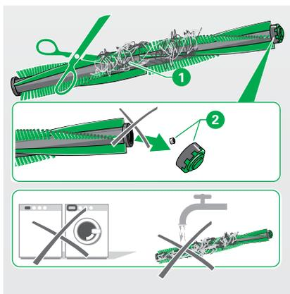
Bild 3.2 Rundbürste reinigen
