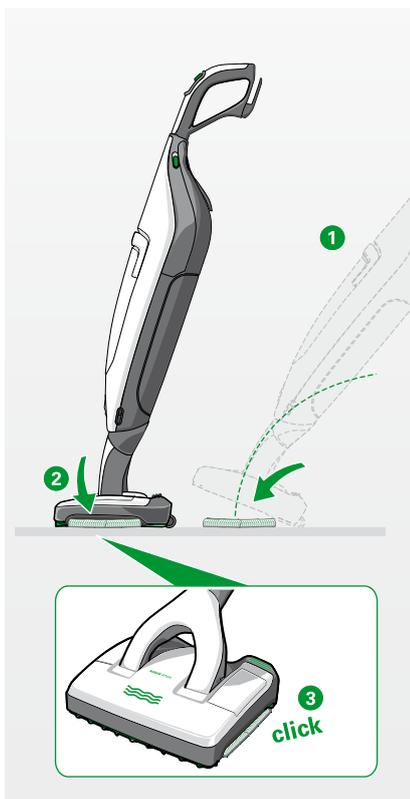
Bild 3.7 Tuchträgerplatte einsetzen
