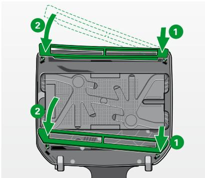
Bild 4.3 Dichtlippenrahmen einbauen
