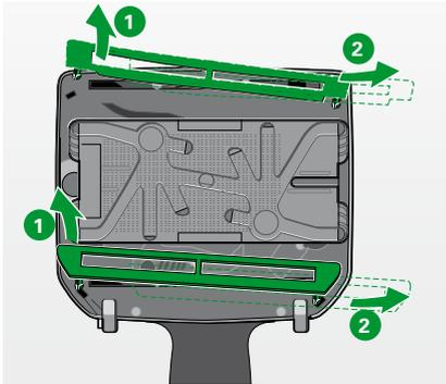
Bild 4.2 Dichtlippenrahmen ausbauen
