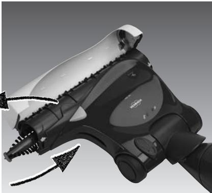
Jetzt ziehen Sie die Rundbürste an dem grünen bzw. roten Ende aus dem Bürstentunnel heraus. Die neuen Rundbürsten drücken Sie mit einer leichten Drehung auf die Antriebswelle, bis zum Anschlag. Achten Sie darauf, dass die Bürsten immer den farbigen Symbolen zugeordnet sind (rot zu rot). Wechseln Sie immer beide Rundbürsten. Kontrollieren Sie den Sitz der Bürsten auf der Antriebswelle.
