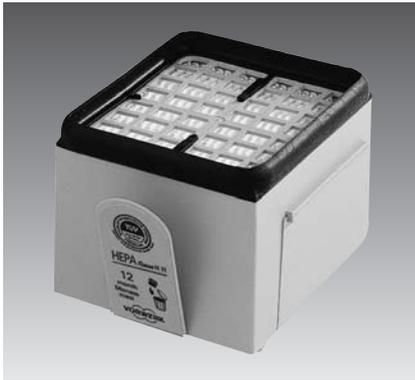
Wechseln Sie den Hygiene-Mikrofilter nach Verbrauch einer ganzen Filtertütenpackung aus (nach ca. zwölf Monaten). Ein verschmutzter Filter kann die Motorleistung beeinträchtigen. Wechseln Sie den Hygiene-Mikrofilter auch bei außergewöhnlicher Verschmutzung, wenn z. B. die Filtertüte geplatzt ist, der Motorschutzfilter stark verschmutzt ist oder Sie aus Versehen ohne Filtertüte gesaugt haben.
