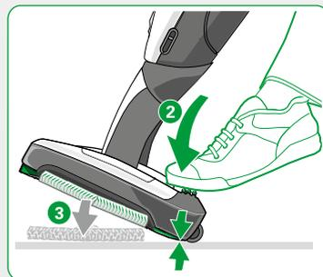
**i** L'estrazione della piastra portapanno è possibile solo quando la Scopa elettrica poggia sulle ruote in posizione di parcheggio, inclinata all'indietro.
