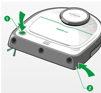
Figura 5.2 Eliminar la red del robot
