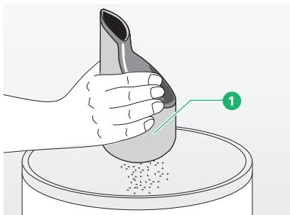
Fig. 4.10 Vuotamento della camera di raccolta polvere
