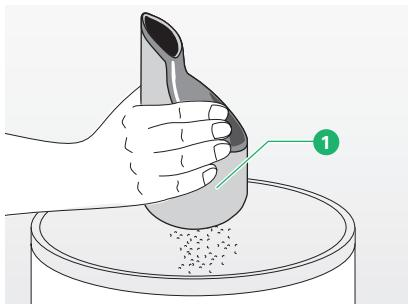
Bild 4.10 Entleeren der Staubkammer
