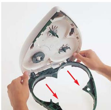
En caso de ser necesario sustituir el cárter que soporta los Módulos de cepillos, abrir la carcasa, sacar el Módulo de cepillos que esté alojado, hacer ligera presión en los puntos de anclaje y tirar suavemente hacia fuera en el sentido que indican las flechas de la foto.
