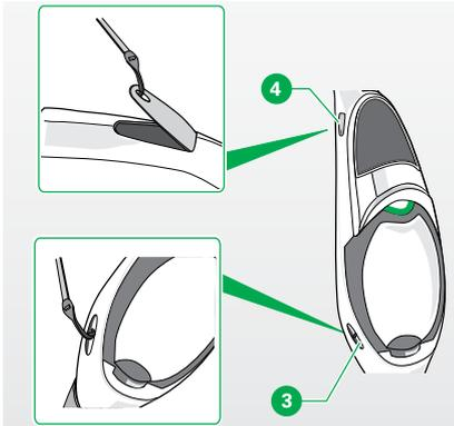
Figura 2.9 Montaje de la correa bandolera
