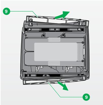
Figura 4.11 Desmontar las faldillas
