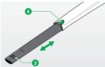
Figura 3.32 Ajuste de la longitud
