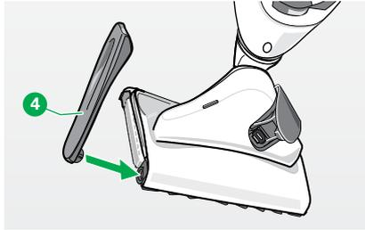
Figura 5.4 Volver a insertar la banda lateral
