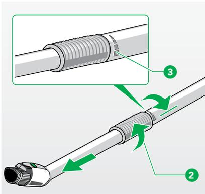
Figura 3.28 Ajuste de la longitud
