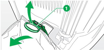
Figura 4.3 Extracción de la bolsa de filtro Premium
