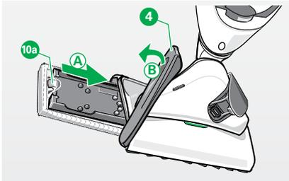
Figura 3.25 Insertar el soporte del paño en el aparato
