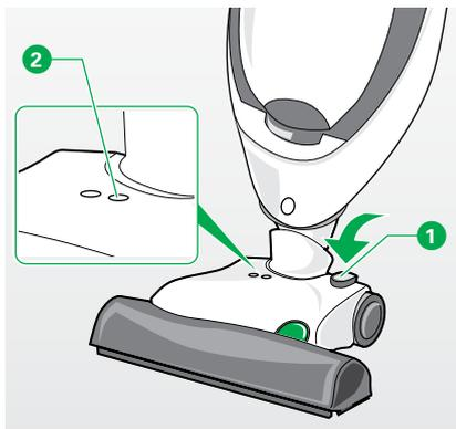
Figura 3.3 Cambio entre la función normal y soft
