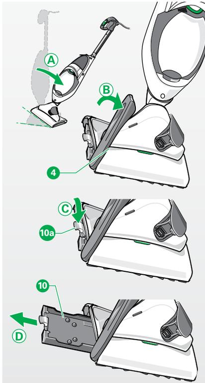
Figura 3.21 Retirar el soporte del paño del aparato
