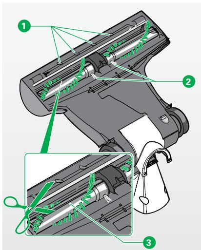
Figura 4.9 Inspección y limpieza de los cepillos giratorios
