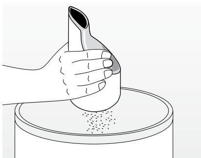
Fig. 4.3 Vidage du compartiment à poussière
