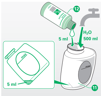
Image 3.22 Remplir le flacon de dosage SP520/530
